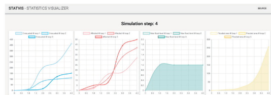
図10 被害量の推定結果 (左から避難完了者数、被害者数、最大浸水値、浸水面積を示す)
