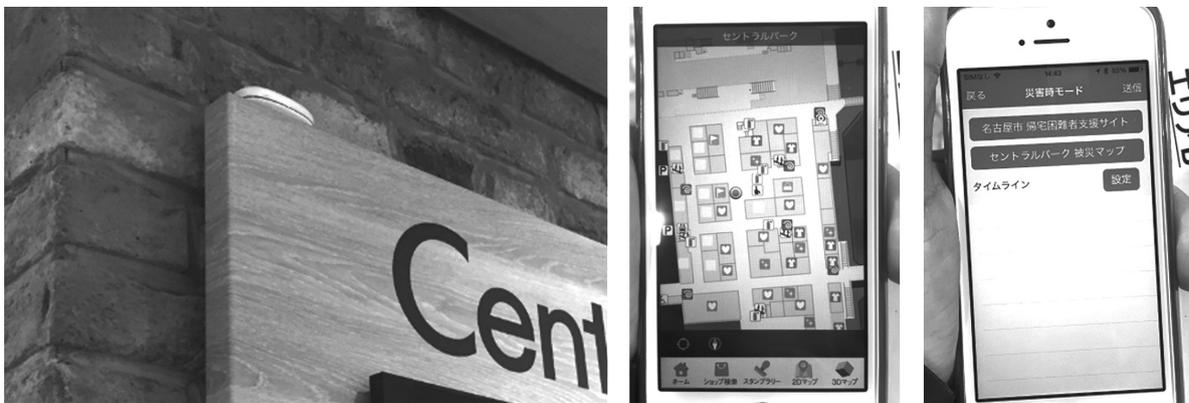
図3.1 iBeacon(BLEタグ) (250個設置)と、B2Cアプリ(中:通常、右:災害モード)
