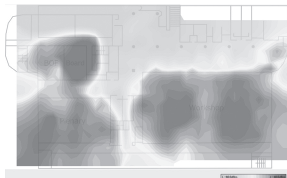
図2.6 5GHz帯のカバレッジ(RSS -40dBm ~ -60dBm)
