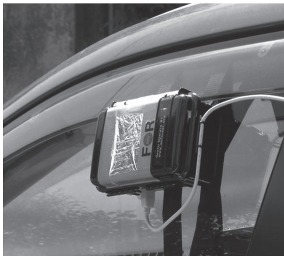
図5.4 車載型の放射線計測装置
