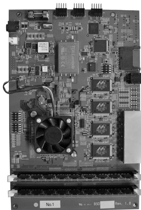
図 2.1. プログラマブル三層構造 FPGA ボードの試作機（トランスニュー・テクノロジー社提供）
