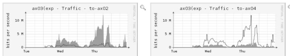
図 2.14. 模倣インターネット網の出入口のトラフィックグラフ (3日間)
