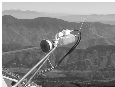
図 4.2. ODU: 大きいユニット (下部) が送信・小さいユニット (上部) が受信を行う
